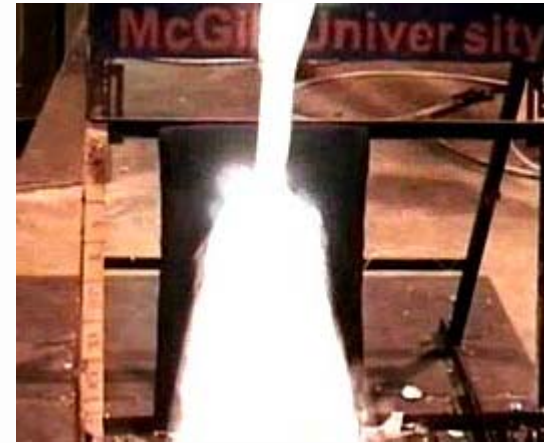
Repelencia total del aluminio cuando entra en contacto con el tejido MARLAN® SX
